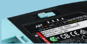
Interrupteur du flux sur le driver
